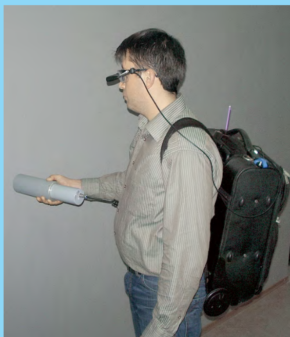
Тренажер портативной системы для тренинга пешей радиационной разведки
