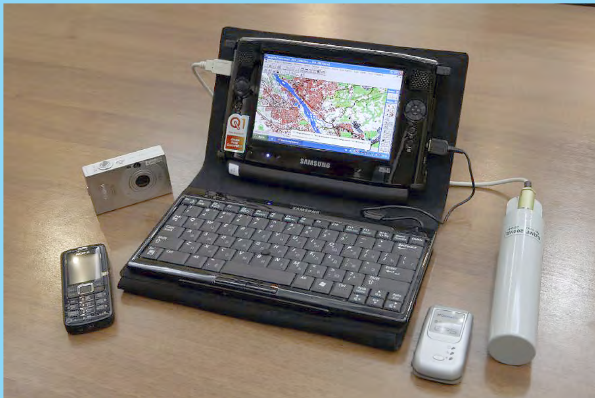
Компактный ноутбук с датчиком GPS и гамма-датчиком
