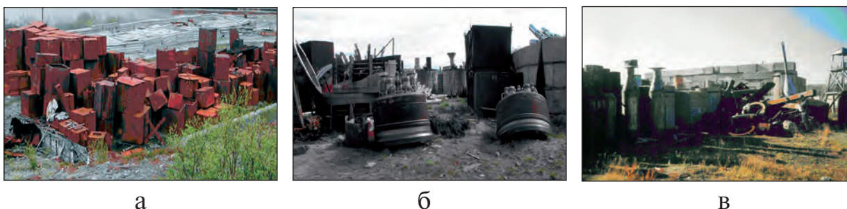
Рис. 2.6.4. Состояние площадок хранения ТРО на БТБ: а) контейнеры для ТРО (бухта Андреева); б) крупногабаритные ТРО (бухта Андреева); в) крупногабаритные ТРО (пос Гремиха)
