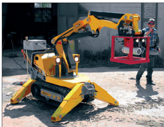
Рис. 7.2.6. Робототехническое средство «Brokk-110», оснащенное гамма-локатором наведения на интенсивные источники
