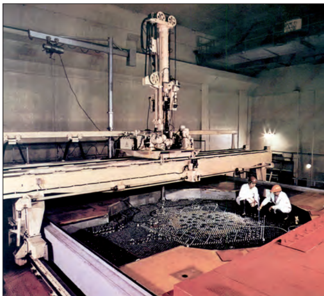
Рис. 3.1.5. Крупнейший в мире стелд для моделирования реакторов на быстрых нейтронах (БФС-2)
