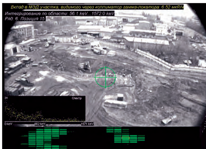
Рис. 7.2.16. Представление первичных данных измерений гамма локатора
