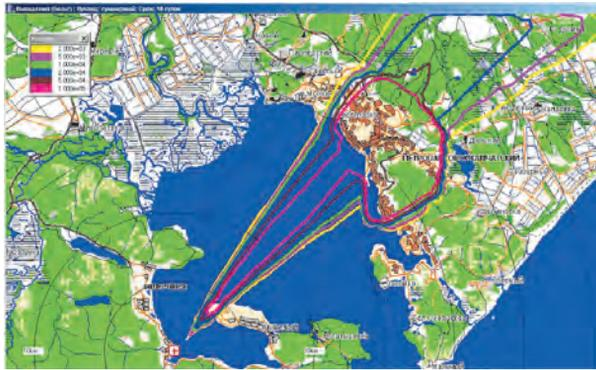
**Рис. 4.14.** Распределение плотности радиоактивных выпадений при наличии атмосферных осадков
