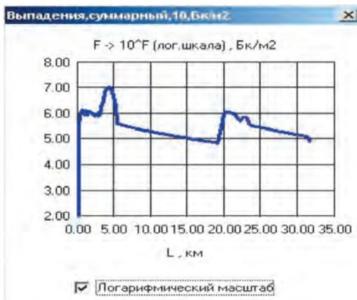
Рис. 4.23. Распределение плотности радиоактивных выпадений по оси следа
