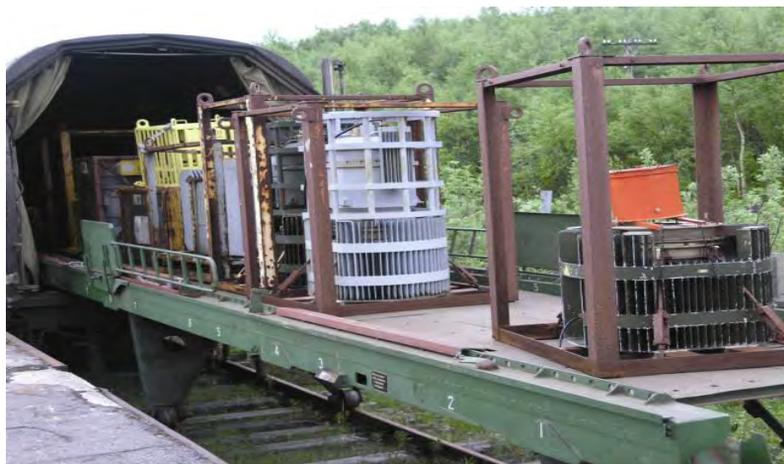
**Рис. 2.34.** РИТЭГи на выдвжной рампе специального железнодорожного вагона перед отправкой во ВНИИТФА
