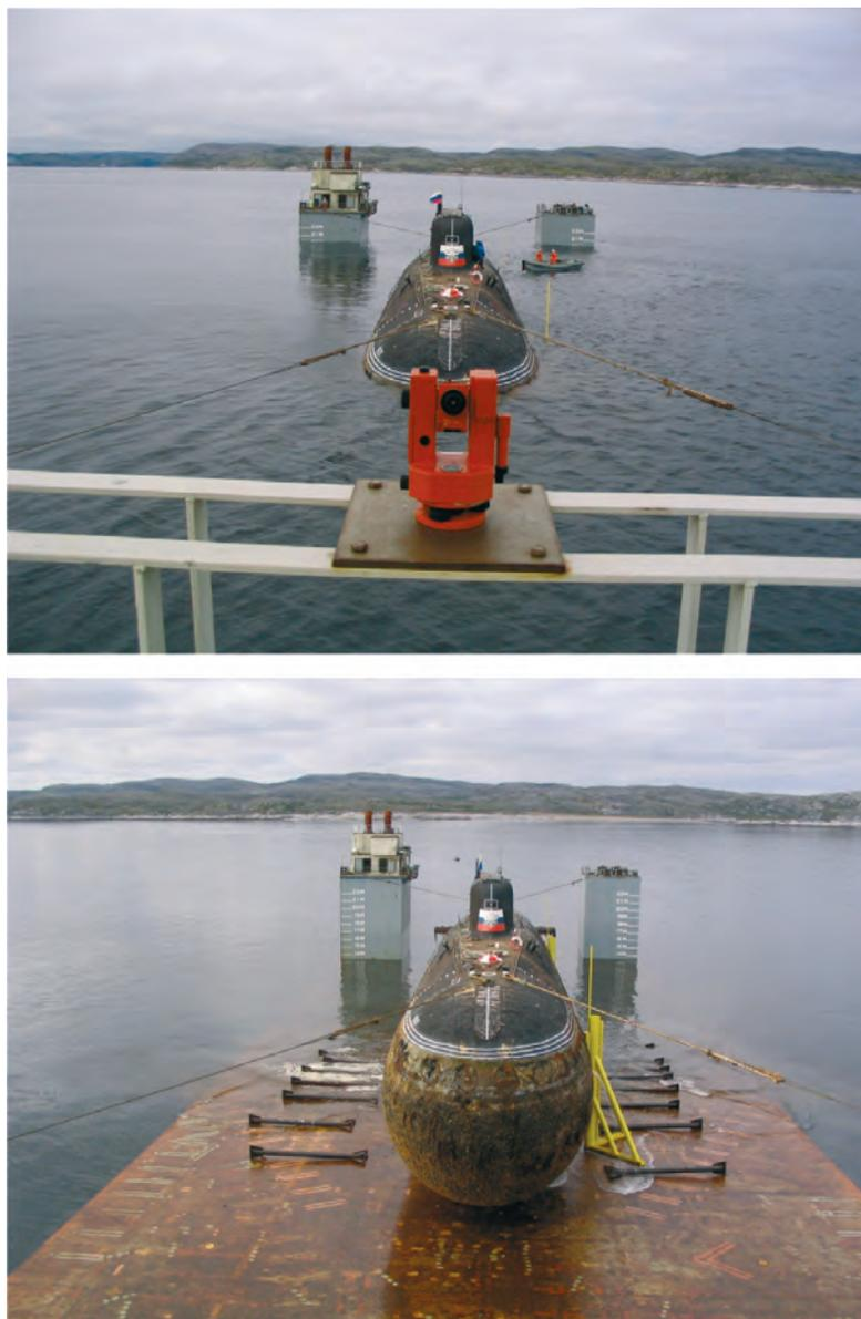
**Рис. 1.40.** Погрузка АПЛ на транспортное судно
