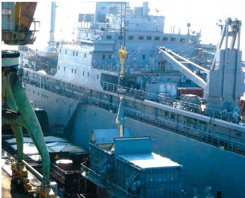
**Рис. 2.12.** Перегрузка ОЯТ при стоянке АПЛ у причальной стенки
