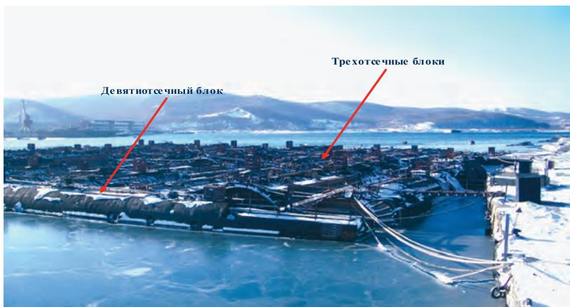
**Рис. 1.8.** Хранение блоков реакторных отсеков на плаву в бухте Разбойник
