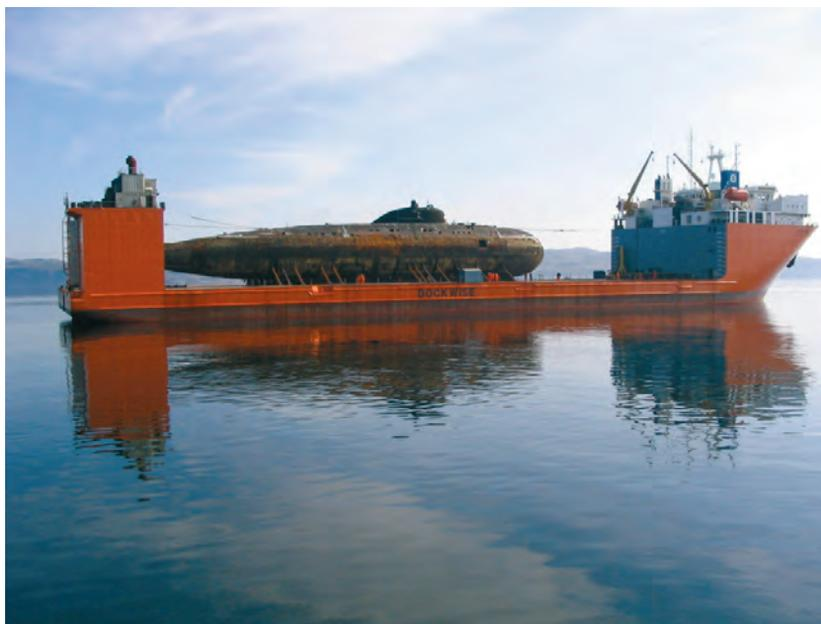
**Рис. 1.39.** Транспортировка АПЛ на погружаемом судне в Баренцевом море
