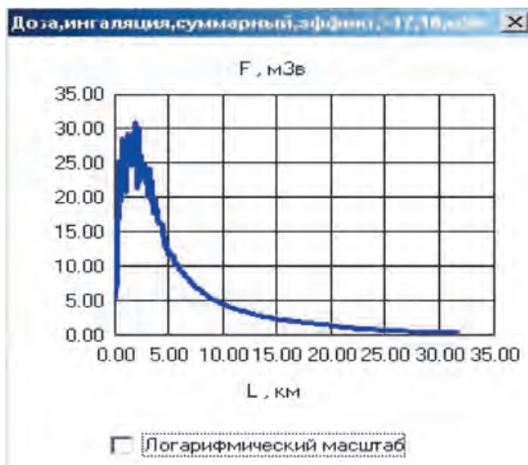
Рис. 4.22. Распределение эффективной ингаляционной дозы по оси распространения радиоактивного облака
