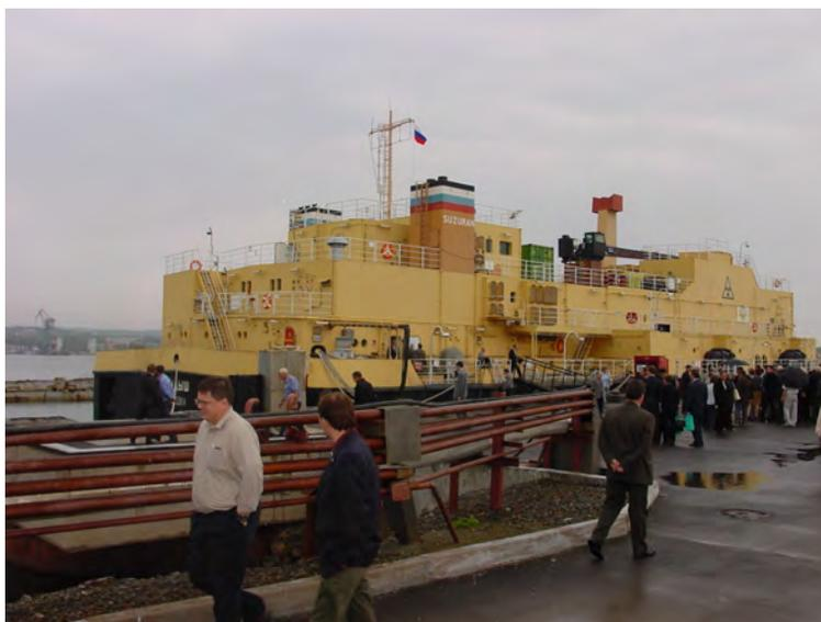
**Рис. 1.30.** Плавучий завод по переработке жидких радиоактивных отходов «Ландыш»
