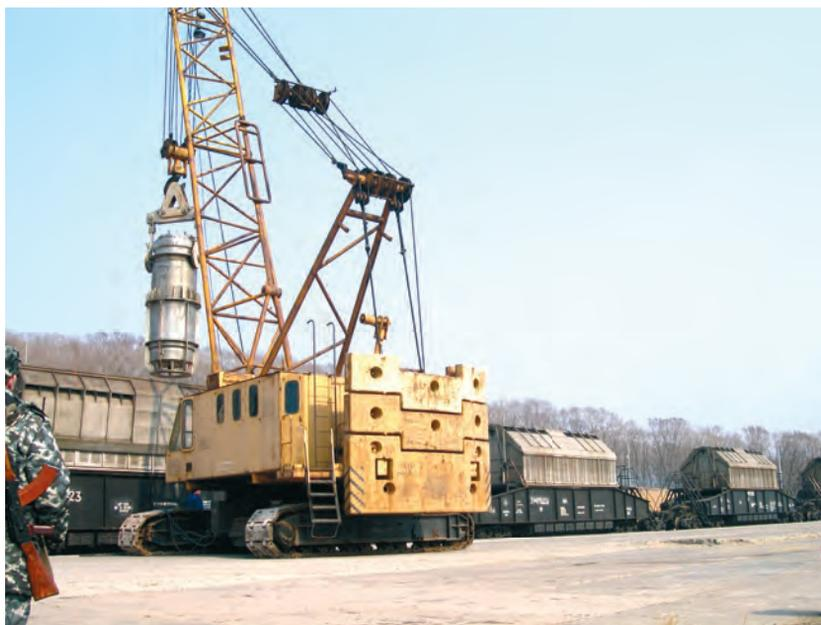
**Рис. 2.9.** Площадка на железнодорожном терминале 54 км станции Дунай. Обращение с контейнерами обеспечивается гусеничным краном СКГ-631 и полуприцепом ЧМЗАП-9990 с автомобильным тягачом МАЗ-537. Площадка оборудована системой электронной физической защиты.
