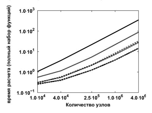
Рисунок 11 — Зависимость скорости расчета от числа узлов расчетной сетки для последовательный расчета (—),технологии OpenMP (---), OpenCL (····),CUDA (-·-)
