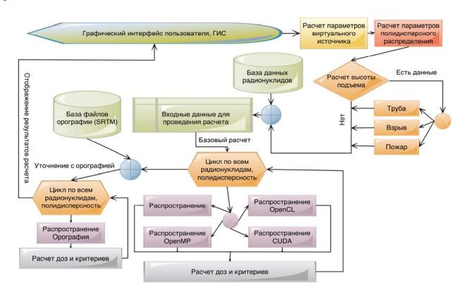
Рисунок 7 — Схема взаимодействия моделей программного средства для выработки рекомендаций по применению защитных мероприятий при обосновании радиационной безопасности населения
