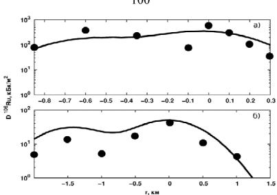
Рисунок 29 – Расчетные (—) и экспериментальные (•) значения плотности поверхностных выпадений Ru-106 при аварии на радиохимическом заводе Сибирского химического комбината (СХК) по срезам следа на расстояниях 4,5 (а) и 12 км (б)
