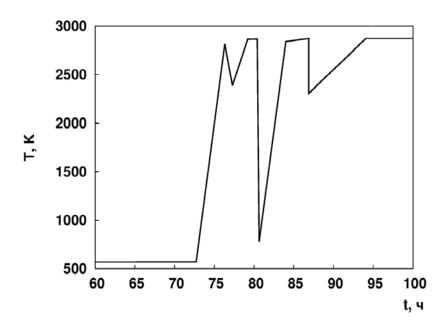
Рисунок 41 – Изменение температуры в активной зоне второго энергоблока АЭС "Фукусима-1" в ходе аварии
