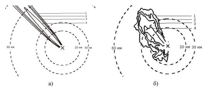
Рисунок 42 — Расчетная (*a*) и измеренная (*б*) плотность выпадений <sup>137</sup>Cs 0,3 (*I*), 0,6 (*2*), 1 (*3*), 3 МБк/м<sup>2</sup> (*4*) [160]
