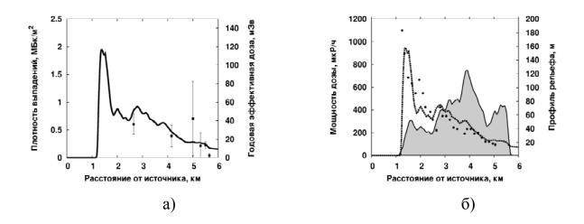
Рисунок 28 — Расчетные (--) и экспериментальные (•) значения плотности поверхностных выпадений(а) Co-60 и мощности дозы (б) при аварии в бухте Чажма
