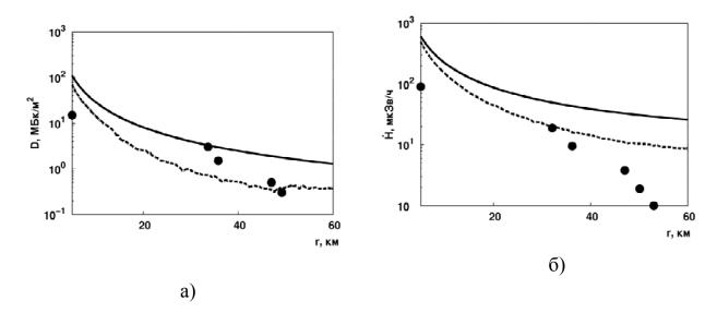
Рисунок 43 — Расчетная с учетом (---) и без учета орографии местности (—) и измеренная ( $\bullet$ ) плотность выпадений  $^{137}$ Cs (a) и мощность дозы ( $\delta$ ) по оси следа на 29 апреля 2011 г [160]
