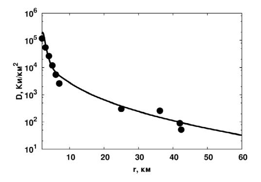
Рисунок 38 – Расчетные (—) и экспериментальные (●) значения плотности поверхностных выпадений Sr-90 при аварии на ПО «Маяк»
