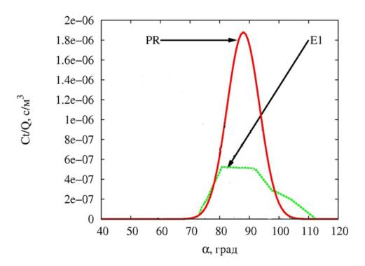
Рисунок 2 – Интеграл приземной концентрации трассера в эксперименте (E1) и рассчитанный с использованием модели РД 2009 (PR)
