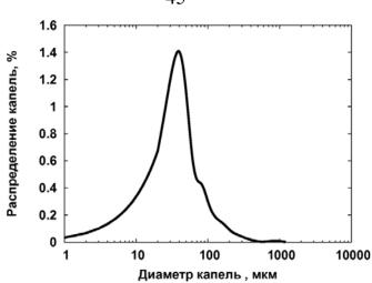
Рисунок 3 — Экспериментальное распределение капель по диаметрам в устье градирни [119]
