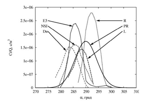
Рисунок 21 — Интеграл приземной концентрации трассера в эксперимент ЕЗ (PR — модель разработанного программного средства, NSI - модель ИБРАЭ «Нострадамус», R - гауссова puff модель (Дания), L - лагранжева модель IABG (Германия), Du - эйлерова модель (Германия))
