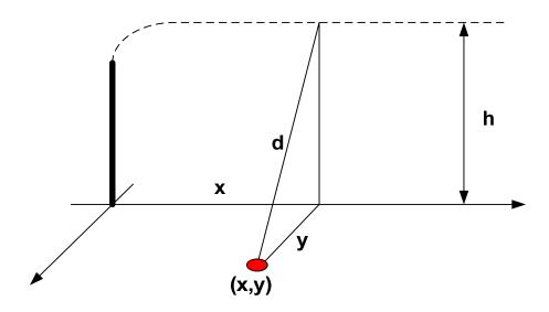
Рисунок 4 — Схема расчета доз внешнего облучения от радиоактивного облака
