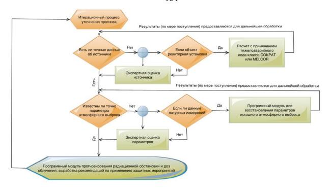
Рисунок 39 — Схема взаимодействия программных средств в рамках единого программного комплекса
