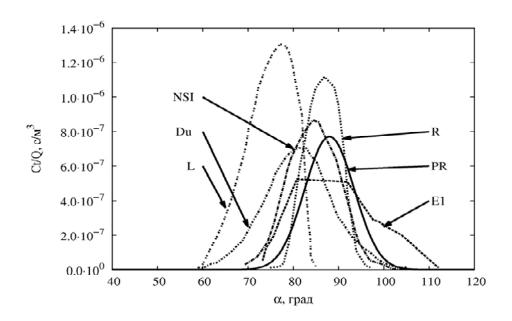
Рисунок 17 — Интеграл приземной концентрации трассера в эксперименте Е1 (PR — модель разработанного программного средства, NSI - модель ИБРАЭ «Нострадамус», R - гауссова puff модель (Дания), L - лагранжева модель IABG (Германия), Du - эйлерова модель (Германия))
