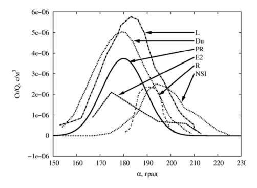
Рисунок 19 — Интеграл приземной концентрации трассера в эксперимент Е2 (PR — модель разработанного программного средства, NSI - модль ИБРАЭ «Нострадамус», R - гауссова puff модель (Дания), L - лагранжева модель IABG (Германия), Du - эйлерова модель (Германия))
