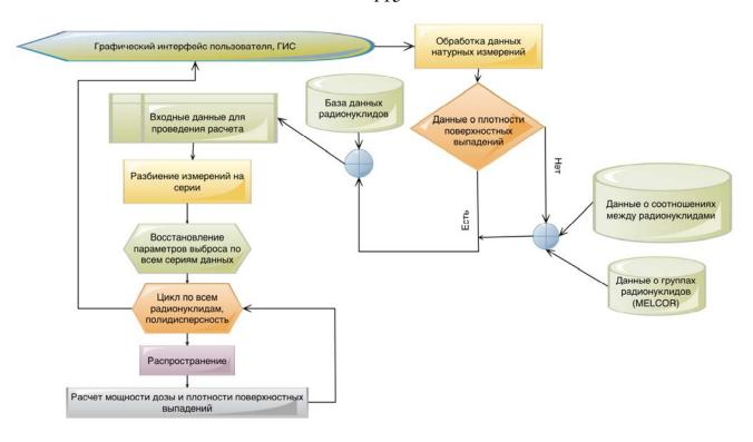
Рисунок 31 — Схема взаимодействия частей программного средства восстановления параметров атмосферного выброса
