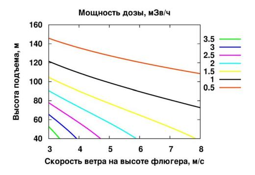
Рисунок 6 — Пример факторного пространства для мощности дозы при варьируемых параметрах скорость ветра - высота подъема. Линиями уровня обозначены соответствующие значения мощности дозы гамма излучения
