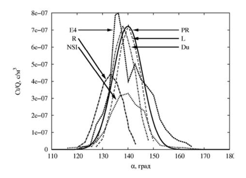
Рисунок 23 — Интеграл приземной концентрации трассера в эксперимент Е4 (PR — модель разработанного программного средства, NSI - модель ИБРАЭ «Нострадамус», R - гауссова puff модель (Дания), L - лагранжева модель IABG (Германия), Du - эйлерова модель (Германия))
