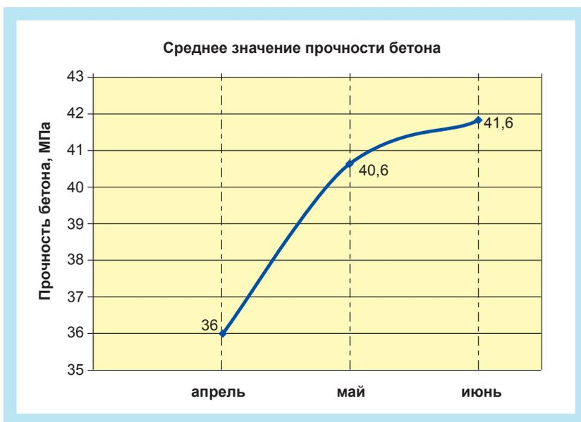
Рис. 3. Динамика изменения прочностных свойств бетона на одном из железобетонных блоков стальной плиты ПДХ РО АПЛ
