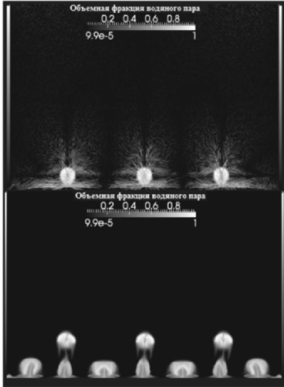
Рис. 15. Объемные фракции водяного пара и векторы скорости вокруг пузырьков во время  $t = 30$  мс и  $t = 70$  мс
