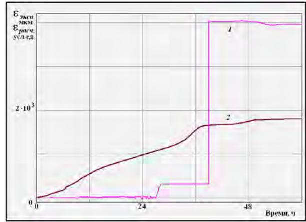
Рис.5. Изменение экспериментальной  $\varepsilon_{\text{эксп}}$  (в мкм) и расчетной  $\varepsilon_{\text{расч}}$  (в усл. ед.) деформации карбонитрида урана (образец №1) в процессе проведения РТСО; кривая (2) построена по детектированному сигналу  $\Delta U_T$
