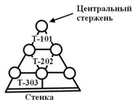
Рис. 2. Расположение термопар в 19-стержневой сборке
