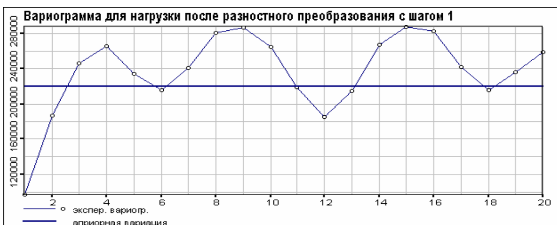
Рис. 64. Вариограмма для нагрузки в электросети за октябрь после процедуры разностного преобразования с шагом 1
