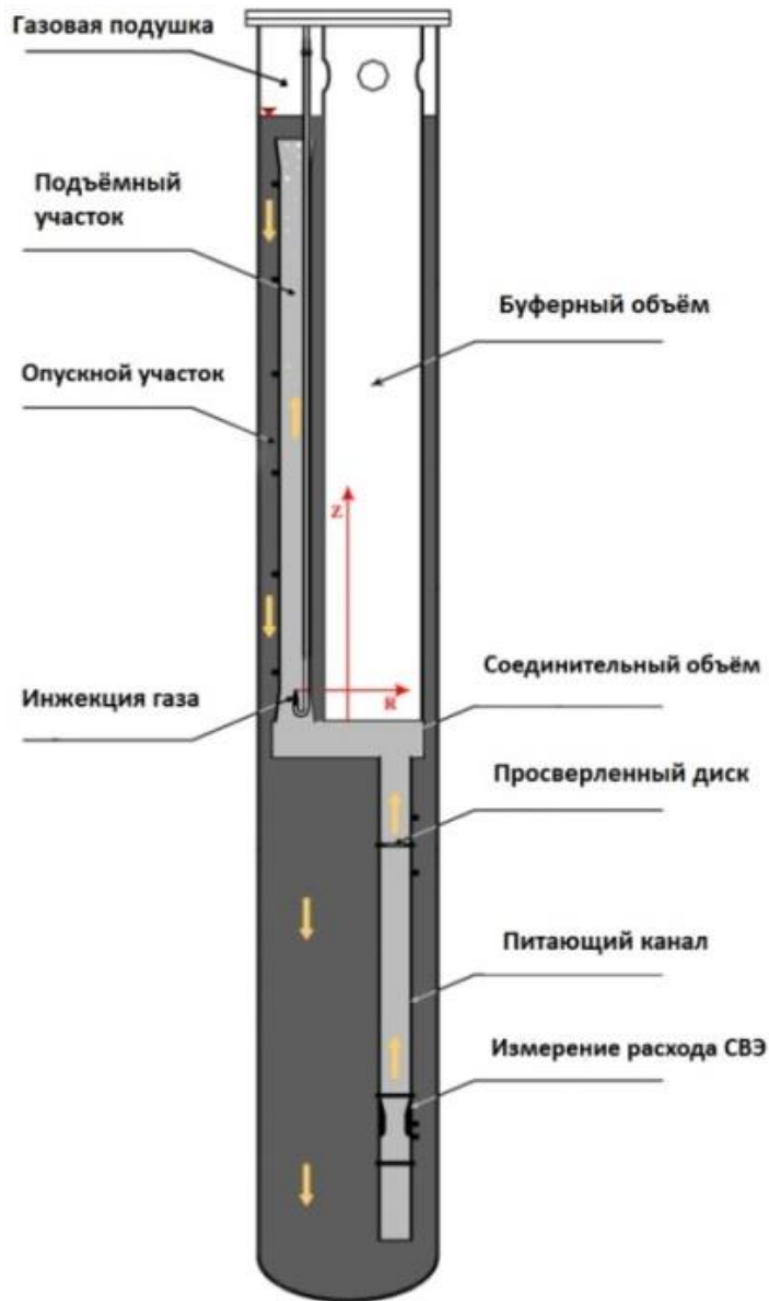
Рисунок 5.6 – Схематичное представление экспериментальной установки (рисунок заимствован из [104], надписи переведены на русский язык автором настоящей работы)
