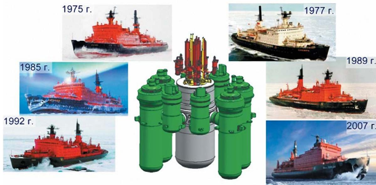
Рис. 3. Второе поколение судовых реакторных установок (ОК-900А)
