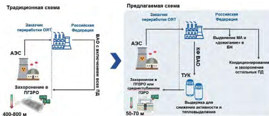
Рис.1 – Перспективная схема переработки ОЯТ
