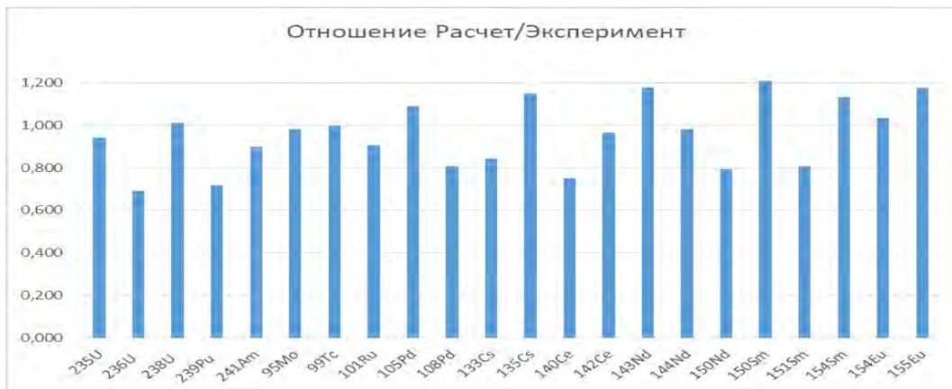
Рис.3. Отношение концентраций Расчет/ Эксперимент для накопления актинидов и продуктов деления в образце 69 при уровне выгорания топлива 31,92 ГВт·сут/тU<sub>исх</sub>
