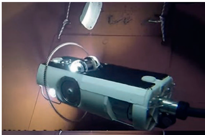
Рис. 27. Прохождение робота через кольцо, установленное ROV-A
