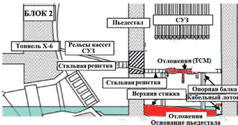
Рис.3. Схема нижних конструкций 2-го блока. Розовым цветом показано возможное положение застывшего расплава (отложений)
