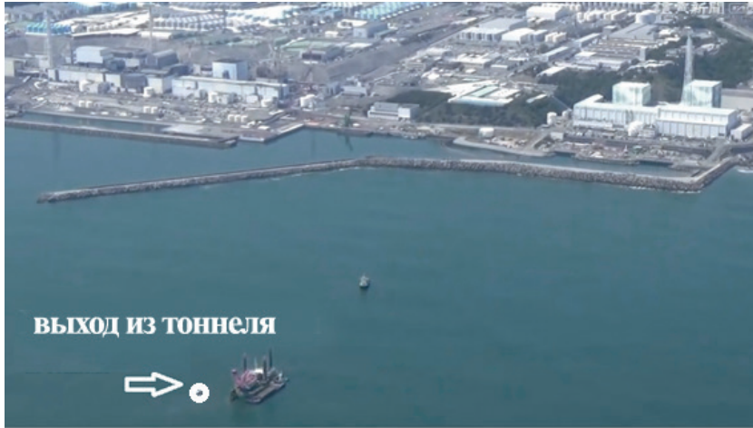
Рис. 15. Судно для исследования морского дна осуществляет мониторинг в районе выхода в океан тоннеля для сброса радиоактивной воды
