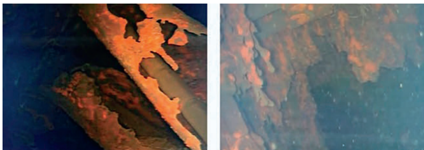
Рис. 37. Слева — «сталактиты», как предполагается, из застывших лавообразных ТСМ (съемка «SUNFISH» 19 июля 2017 г.). Справа — отложения этих ТСМ (21 июля 2017 г.)
