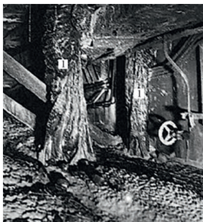
Рис. 14. «1» — натёк ЛТСМ в пом. 217/2, один из «сталактитов»
