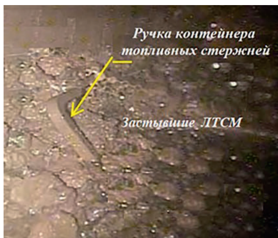
Рис. 1. ЛТСМ во 2-м блоке АЭС «Фукусима-1». Среди застывших лавоподобных отложений видна ручка контейнера топливных стержней
