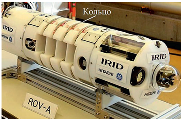
Рис. 26. Общий вид робота ROV-A. Кольцо освобождается и магнитом прикрепляется к стенке контейнента
