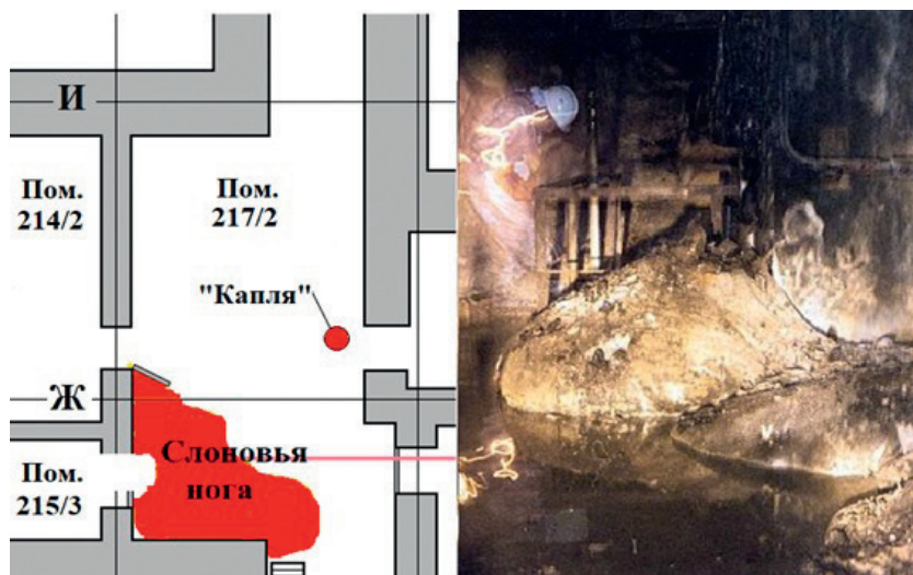
Рис. 9. Скопление ЛТСМ «слоновья нога» в помещении 217/2
