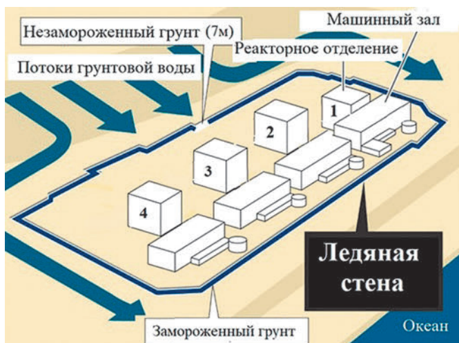
Рис. 4. В августе 2016 г. 99 процентов «Ледяной стены» были завершены, оставили только 7-метровую секцию для контроля
