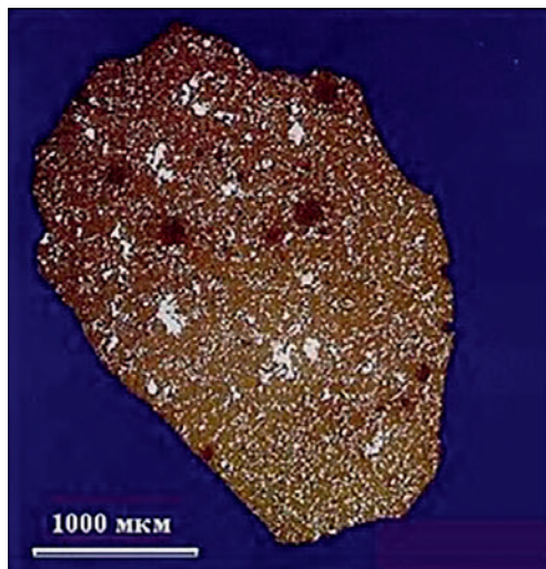
Рис. 4. Полированный препарат коричневой лавы. Изображение было получено в обратно-рассеянных электронах. Видны разнообразные включения в матрицу, при этом светлые пятна — включения урановых и уран-циркониевых фаз
