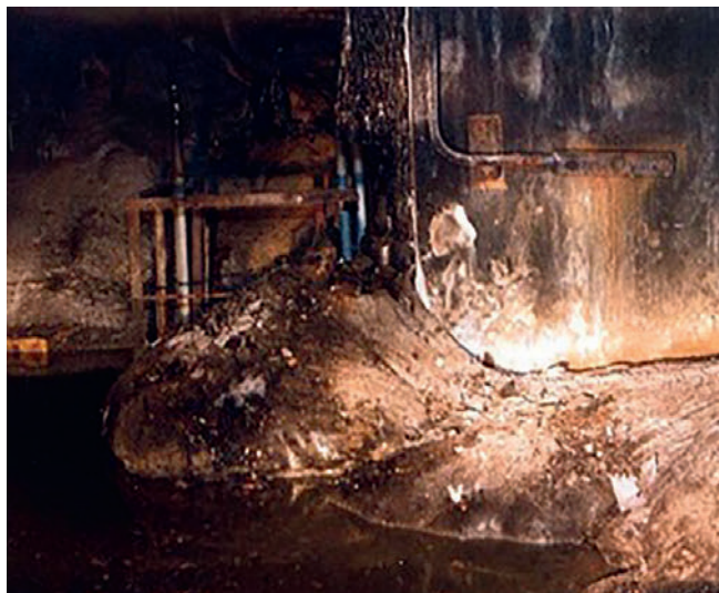
Рис. 12. Помещение 217/2. Скопление ЛТСМ — «Слоновья нога»
