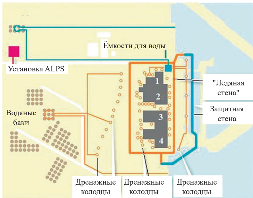
Рис. 3. Схема размещения на площадке F-1 систем по обращению с загрязнёнными грунтовыми водами
