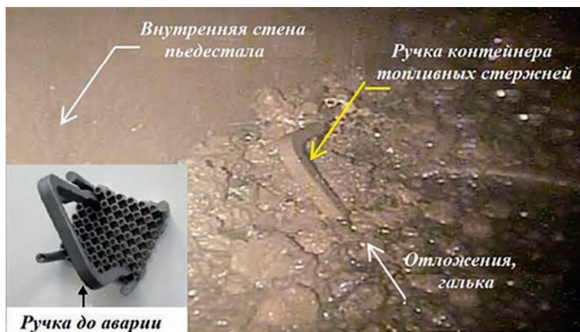
Рис. 13. Ручка контейнера топливных стержней среди отложений на пьедестале
