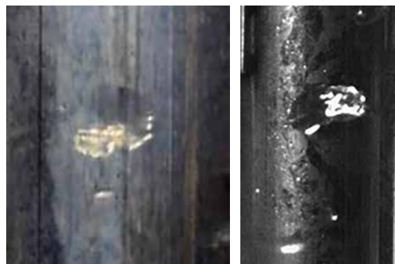
Рис. 2.1.18 – Сравнение формы газового пузыря в жидком свинце (слева), Eo = 28 , T = 450^\circ\text{C} , и свинцово-висмутовом расплаве (справа), Eo = 34,1 , T = 160^\circ\text{C}
