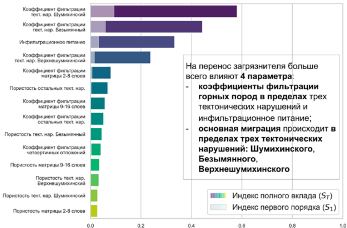
Рис. 2.2.20 – Результаты анализа чувствительности при помощи MOUSE на примере трехмерной модели площадки планируемого ПЗРО
