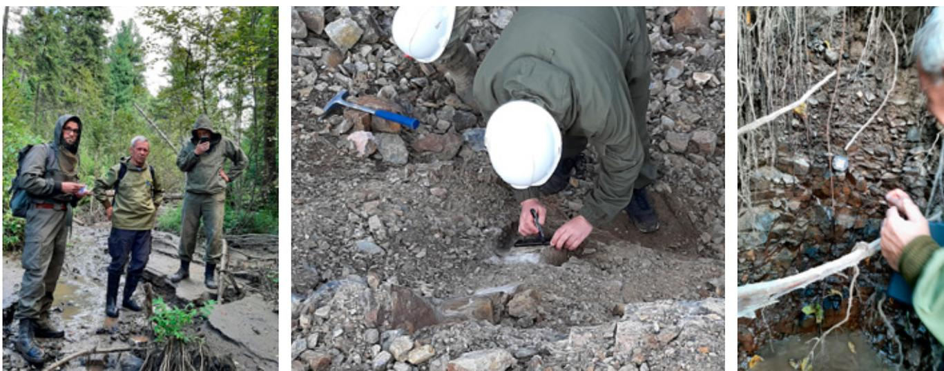
Рис. 2.2.11 – Рекогносцировочные геологические обследования – замеры положения элементов неоднородностей массива на породных обнажениях, отбор образцов горных пород
