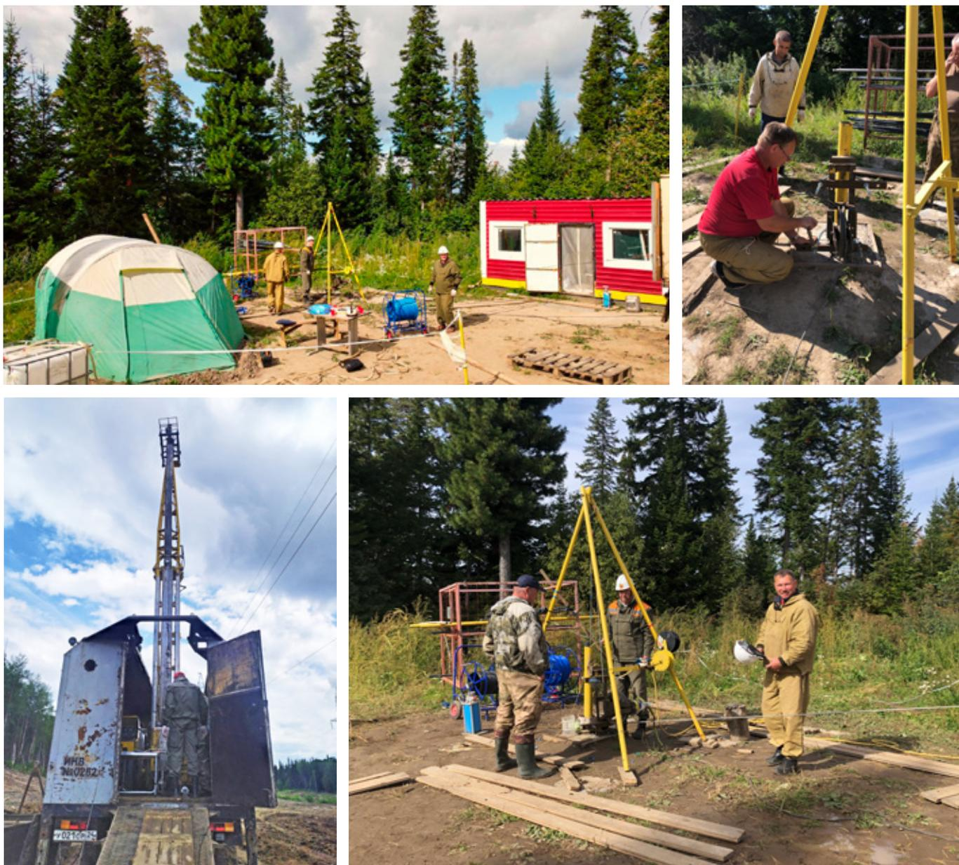
Рис. 2.2.10 – Отработка технологии скважинных нагнетаний и построения напорного профиля скважин в 10-метровых интервалах
