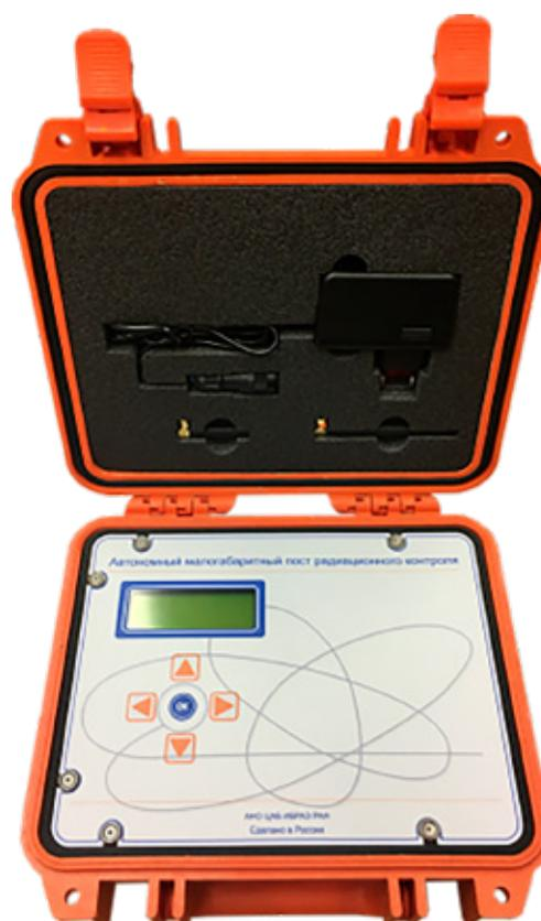
**Рис. 2.3.5** – Автономный малогабаритный пост радиационного контроля
