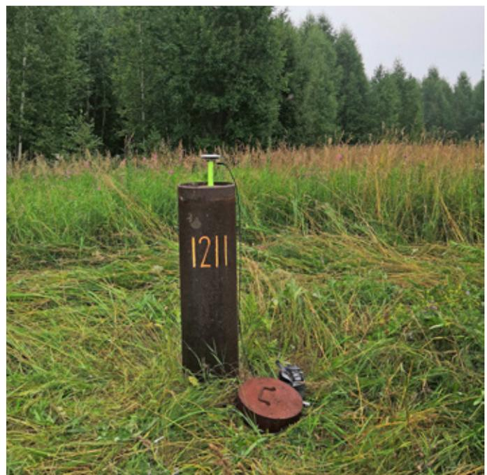
Рис. 2.2.9 — Спутниковые измерения на пунктах геодезической сети геодинамического полигона
