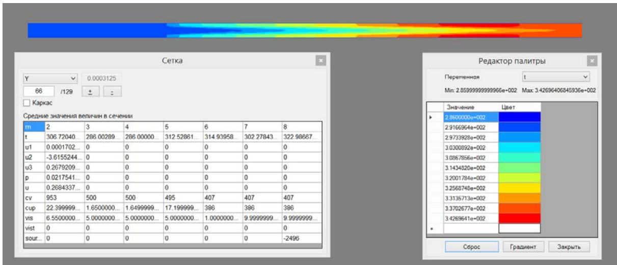
Рисунок 36. Распределение температуры t в среднем сечении сетки вдоль оси Y
