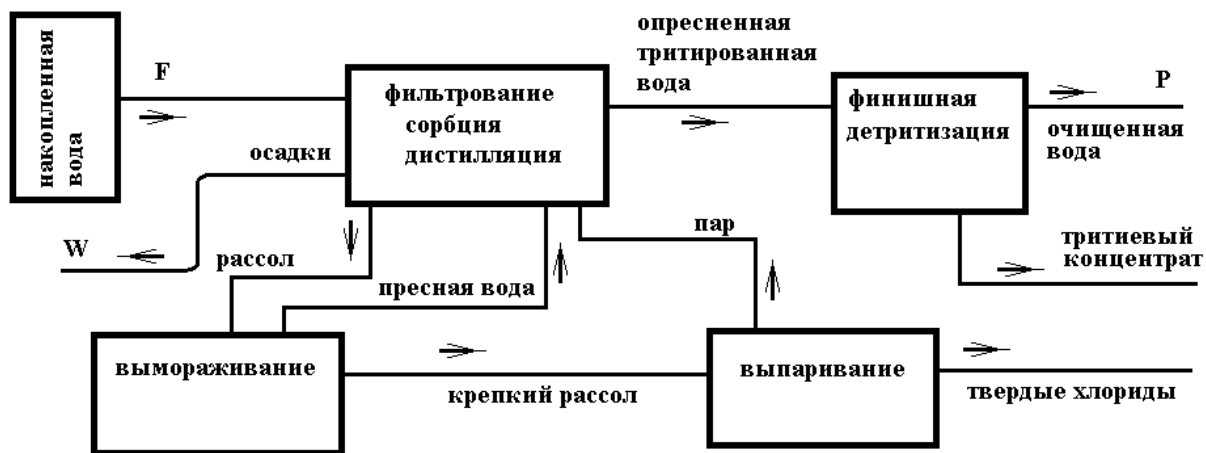
Рис. 1. Максимальная программа переработки вод Фукусима 1. F - исходная вода (питающий поток), P – очищенная по тритию вода, W – хлоридный отвал.
