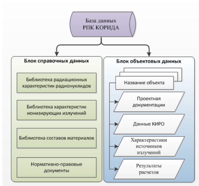
Рис. 6 Схема организации базы данных РПК КОРИДА
