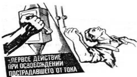
Рис. 1. Освобождение пострадавшего от действия электрического тока путем отключения электроустановки
